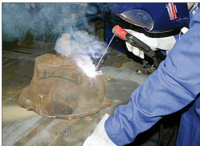
L'arco elettrico genera una produzione di calore intensa e concentrata, fusione e vaporizzazione di metalli all'interno dell'arco, con emissione di gas e di vapori surriscaldati e tossici, proiezione di particelle incandescenti, elevata intensità di radiazione elettromagnetica particolarmente nella gamma di raggi ultravioletti (UV) ed infrarossi (IR), ma anche nel campo della luce visibile che può portare a danni irreversibili alla pelle e agli occhi.
