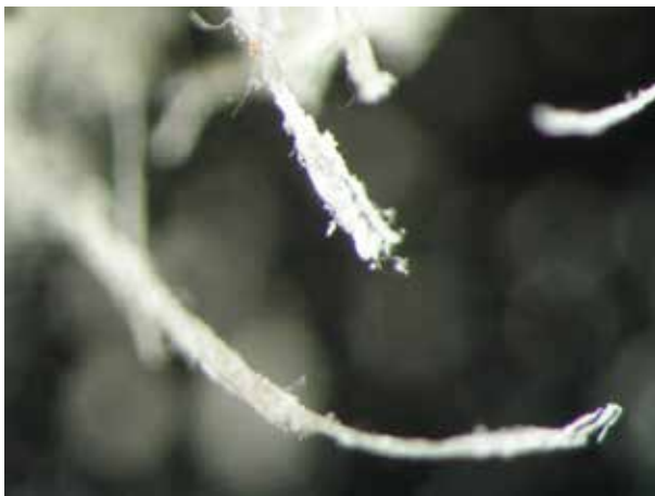
Particolare di fibra di amianto (63x)
